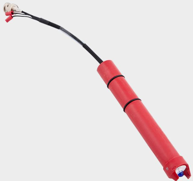
**Le ST857 est une électrode rétractable très résistante et étanche, conçu pour les applications d'insertion/rétraction.**
